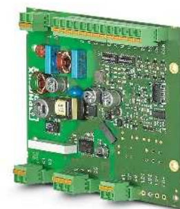
基本型交流充电控制器, PCB, 充电方式C 带MSTB连接
