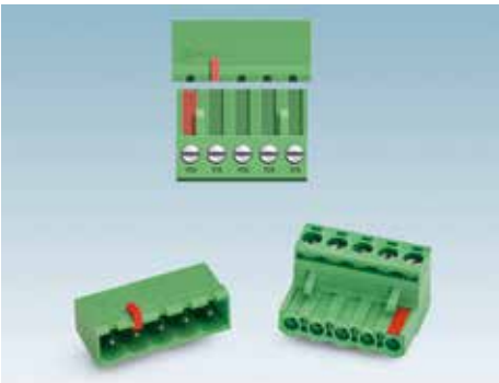
防误插编码 采用特殊编码标签和编码条防止误插拔
