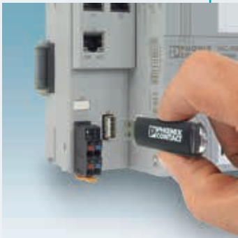
可插拔USB外置接口 用于固件升级，数据储存
