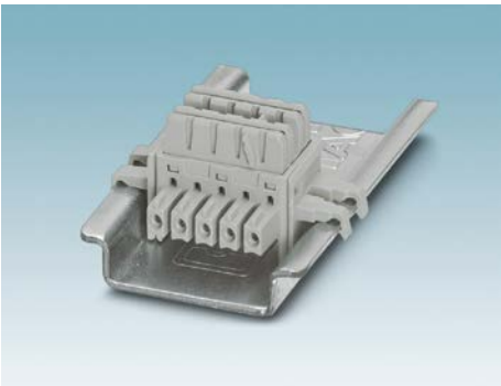
DIN导轨连接器 ME 6,2 TBUS-2 1,5/5-ST-3,81 GY 订货号: 2695439 灰色, 每个可安装两个MINI Analog Pro模块。 ME 17,5 TBUS 1,5/5-ST-3,81 GN 订货号: 2709561 绿色, 用于安装MINI-SYS系统电源 (需要2个)。
