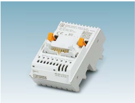
系统布线 MINI MCR-2-V8-FLK 16 订货号: 2901993 系统适配器可快速无误地将八个MINI Analog Pro信号隔离变送器连接到控制器上。
