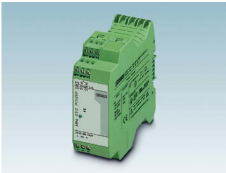
电源 MINI-SYS-PS-100-240AC/24DC/1.5 订货号: 2866983 MINI-PS-100-240AC/24DC/1.5/EX 订货号: 2866653 (适用于Ex区) • 宽域输入: 85 ... 264V AC (45 - 65Hz) • 输出电压: 24V DC ±1% • 输出电流: 60°C时1.5A/40°C时2A
