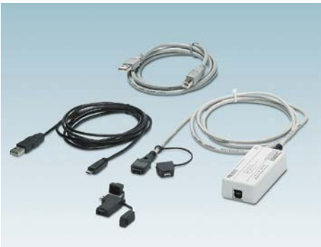
编程适配器 IFS-USB-PROG-ADAPTER 订货号: 2811271 USB编程适配器, 通过PC机编程。 IFS-BT-PROG-ADAPTER 订货号: 2905872 编程适配器, 通过蓝牙实现无线通信。 TWN4 MIFARE NFC USB ADAPTER 订货号: 2909681 NFC编程适配器, 带USB接口, 可用于无线配置支持NFC功能的产品。
